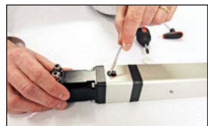
Motorkupplungsschrauben anziehen und Dichtstopfen einsetzen
